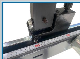
Vernier millimétré (modèle sortie)
