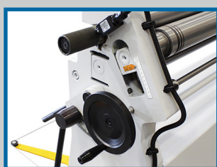
Volant de montée/baisse du rouleau arrière
