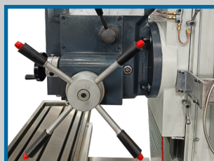
Cabestan avec enclenchement des avances auto
